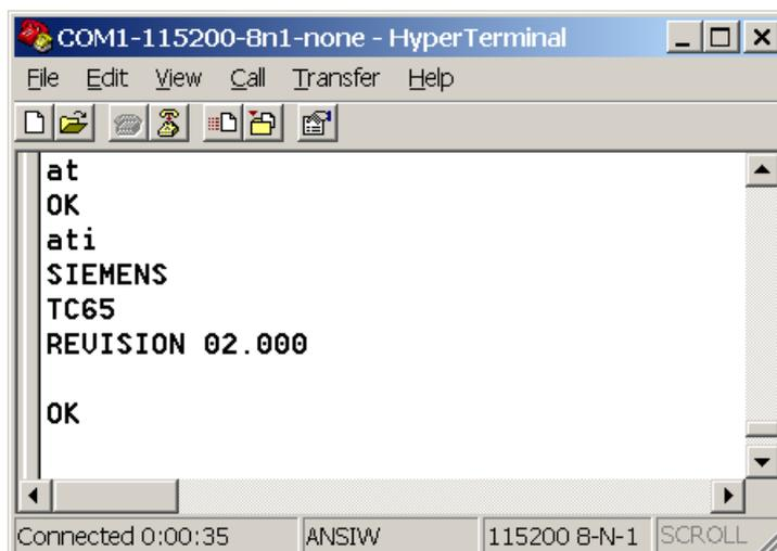
Не забудьте, что доступ к файловой системе модуля не может работать одновременно с терминальными программами, т.к. использует один и тот же COM-порт.
