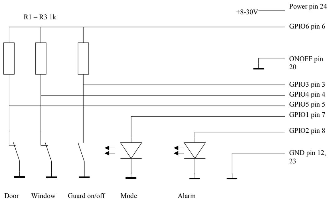
Постановка на охрану и снятие с охраны осуществляется нажатием кнопки, подключенной между общим проводом и входом GPIO3. Программа встает на охрану через заданное в настройках время после нажатия.
